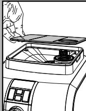
**Заполняйте резервуар только свежей негазированной водой. Горячая вода может нарушить работу аппарата. Не включайте аппарат, если резервуар для воды пуст: убедитесь, что в резервуаре есть вода.**
