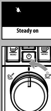
20 Готовьте горячую воду до тех пор, пока не загорится сигнал; затем поверните рукоять против часовой стрелки, чтобы вернуть её в центральную позицию.
