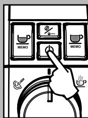
Чтобы включить аппарат снова, просто нажмите на кнопку Stand-by (если кнопка включения установлена на "I"). В этом случае аппарат начнёт цикл полоскания только если бойлер холодный.
