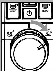
2 Только после добавления смеси для чистки от накипи в резервуар, поверните рукоять по часовой стрелке до позиции , и затем приготовьте 2-3 чашки воды (примерно 150 мл)
