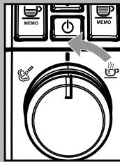
\* Заполните чашку горячей водой до необходимого уровня; чтобы остановить подачу воды, поверните рукоять против часовой стрелки обратно до позиции . Аппарат возвращается в стандартное положение.
