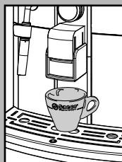
Вручную двигайте кран вверх и вниз, чтобы максимально адаптировать его высоту к высоте кружки.
