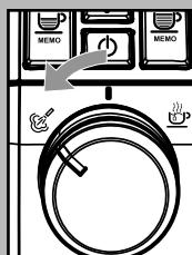
\* Когда аппарат будет готов к приготовлению напитка, поверните рукоять против часовой стрелки, чтобы установить его в позицию . Остатки воды могут выходить через кран.
