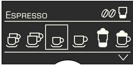
In de regel "status" **5a** van het display **5** wordt de naam van de drank en de ingestelde sterkte, bijv. **00**, en hoeveelheid, bijv. **□**, vermeld. In de regel "keuze" **5b** verschijnen symbolen voor de drankkeuze. De pijltjes in de regel "navigatie" **5c** geven aan in welke richting er zich nog menu-items bevinden.
